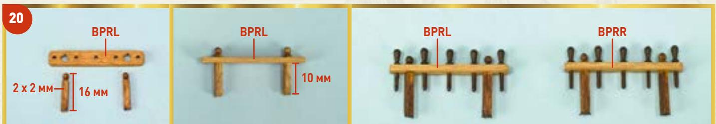
**20** Повторите описанные в шагах 14 и 15 операции: соберите и покрасьте две кофель-нагельные планки BPRL и BPRR. Для изготовления их стоек используйте фрагменты планки сечением 2 x 2 мм и не забывайте сверяться с размерами, приведенными на фотографиях. По завершении сборки вклейте в каждую планку по пять кофель-нагелей.
