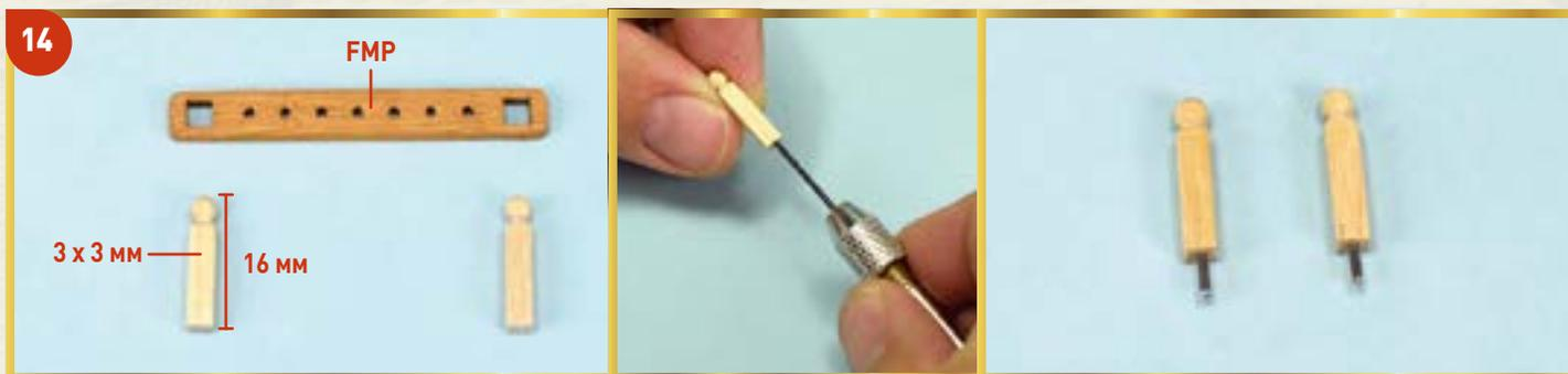
**14** Покрасьте деталь FMP так же, как и деталь BHR. Затем из фрагмента планки сечением 3 x 3 мм изготовьте две стойки длиной по 16 мм. Мы советуем вам в нижних концах этих стоек просверлить небольшие отверстия и вклеить в них металлические штифты.
