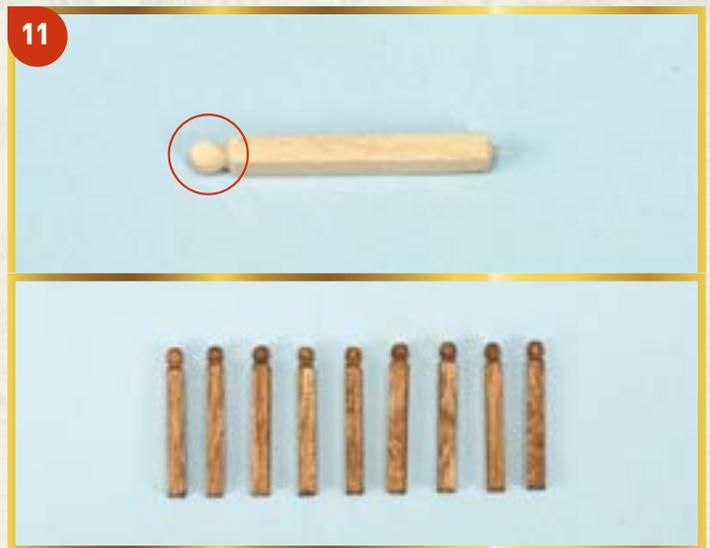
**11** С помощью надфиля обработайте конец отрезанного фрагмента планки так, как показано на фотографии сверху. Затем покройте фрагмент морилкой цвета «лесной орех». Аналогичным образом изготовьте еще восемь таких деталей.
