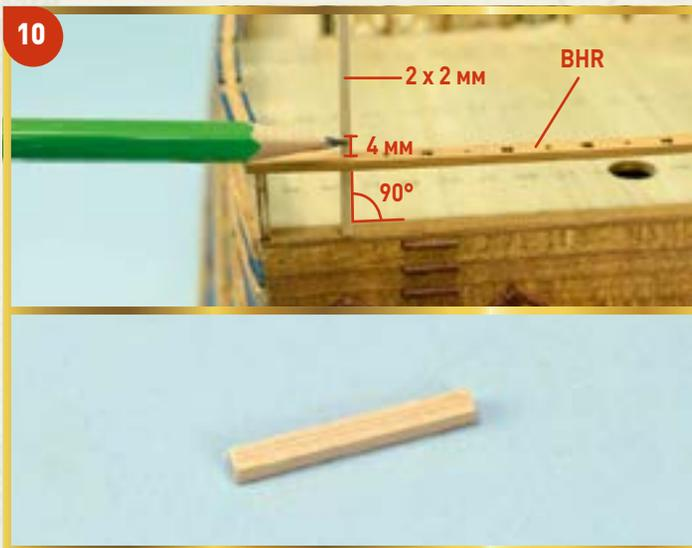
**10** Вставьте планку сечением 2 x 2 мм в одно из крупных отверстий детали BHR. На расстоянии 4 мм от детали BHR карандашом нанесите на планку метку, а затем обрежьте ее по этой метке.
